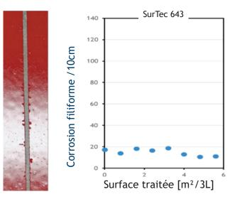
Avec une Moyenne de moins 20 points de corrosion filiformes pour 10 cm de long et un point de moins de 1mm de long, SurTec 643 montre une excellente protection contre la corrosion.
